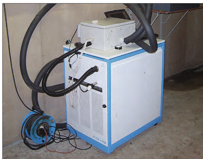
Figur 1. PTR-MS opstillet ved forsøgsstald. Oven på instrumentet ses en opvarmet ventilbox (multiplekser), der automatisk sørger for at udtage prøver de udvalgte steder i stalden. Instrumentet suger selv prøveluften ind i reaktionskammeret.
