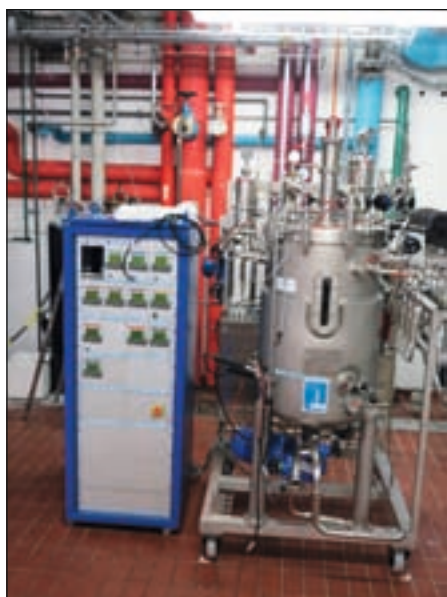
Figur 1. Et set-up med to fermentatorer på 70 liter/15 liter tilknyttet samme kontrolenhed.
