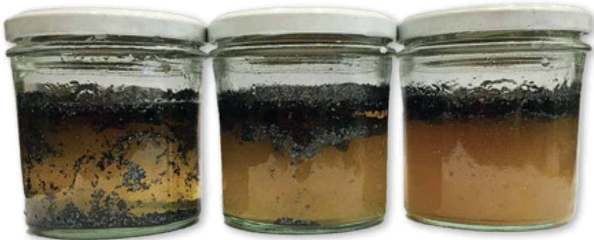
Prøver af saltblandinger med grafitflager og forskellig koncentration af fortykkelsesmiddel.
