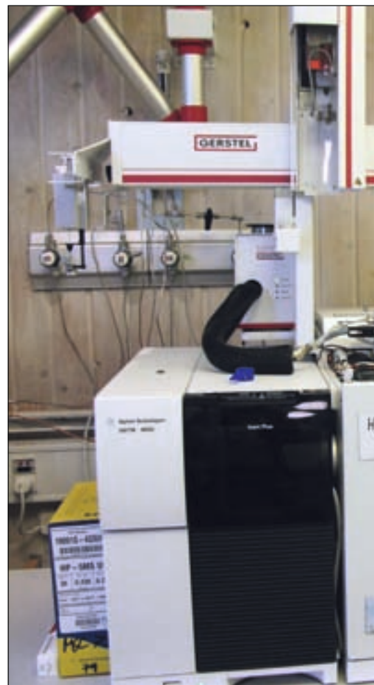
Figur 1. Billeder af det anvendte udstyr. A) GC-MS med tilhørende multipurpose sampler. B) Dynamic headspace. C) Termisk desorptionsenhed.
