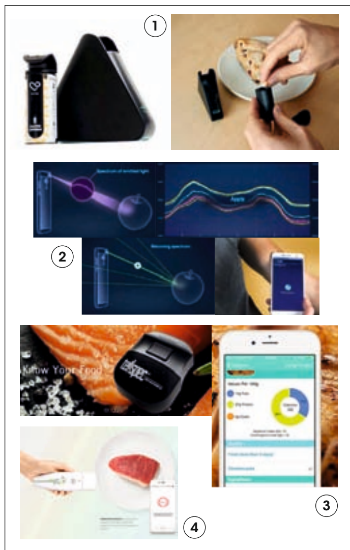
Figur 1. Eksempler på analytiske systemer rettet mod forbrugere: et NIR-spektrofotometer fra Tellspec (3) ( http://tellspec.com/en/ ), der netop har slået sig ned i Aarhus, en glutensensor fra Nima (1) ( https://nimasensor.com ) eller måske en FoodSniffer (4) ( http://www.myfoodsniffer.com ), der kan afgøre, om kødet er frisk, måske en H 2 -smartphone med NIR-spektrometer fra et samarbejde mellem Consumer Physics og Changhong (2) ( https://www.phone.consumerphysics.com ).
