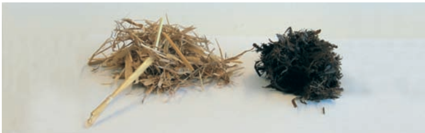
Figur 1. Hvedehalm før og efter forbehandling i IBUS-forbehandlingsanlægget [1]. Efter forbehandlingen er meget af den oprindelige struktur af halmen stadig intakt. Tørstofindholdet i den forbehandlede halm er omkring 30%.
