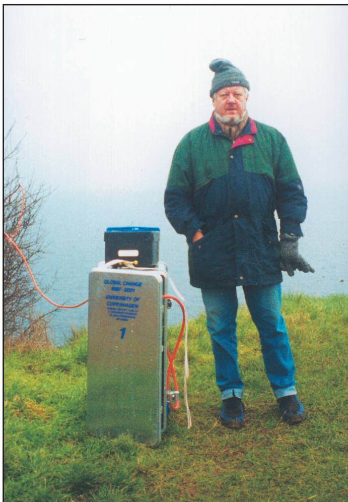
Et billede fra Stevns Klint ved Højerup fra februar 2000. I vintrene 1998-2000 opsamledes \text{CO}_2 -prøver som \text{BaCO}_3 , som senere blev analyseret for ^{14}\text{C} i Århus. Ideen var at følge luft fra det kulfyrende Centraleuropa op til Nordatlanten. Der blev således også opsamlet prøver på Shetlandsøerne, Færøerne og Island. Undersøgelserne var led i NEAREX-projektet.
