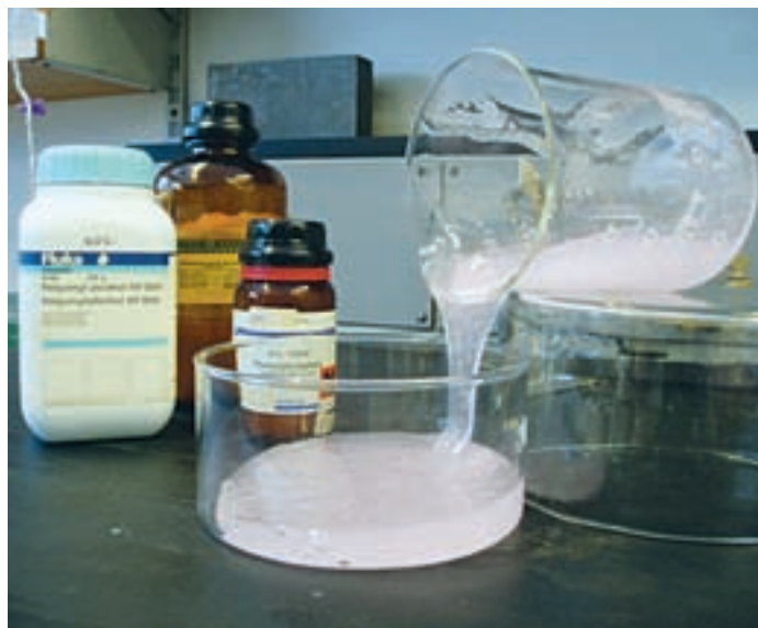
»En polymer og et netværk«, den thermochrome gel af polyvinylalkohol (PVA) krydsbundet med borationer, [B(OH)_4]^- .
