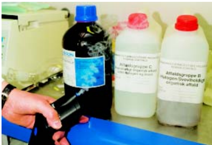
En røgudvikler kan visualisere luftstrømninger, men er ikke nogen egentlig kontrol af stinkskabets sugeevne.
