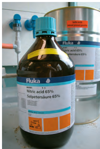
Nogle firmaer anvender coatede glasflasker til koncentreret salpetersyre, og emballagestørrelsen er højst 2,5 liter. Foto: Jørgen Stage Johansen.
