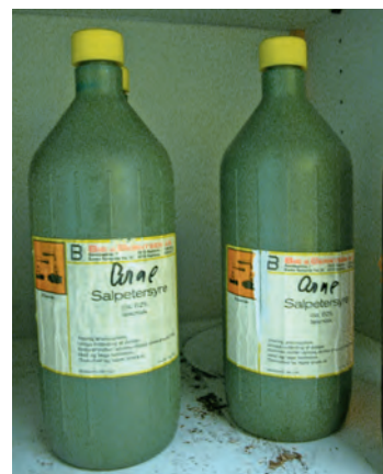
Ved ulykken på Københavns Universitet [1] sprang bunden af en grøn flaske sammen til disse. Materialet var helt hvidt og hårdt efter mange års opbevaring. Foto: Jørgen Stage Johansen.
