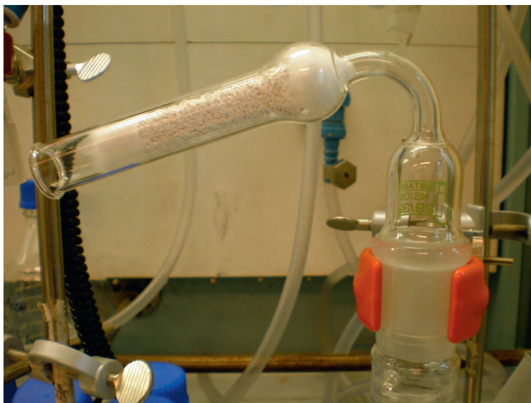
Calciumchlorid-tørrerør. Måske skal \text{CaCl}_2 ned i kolben fremover?
