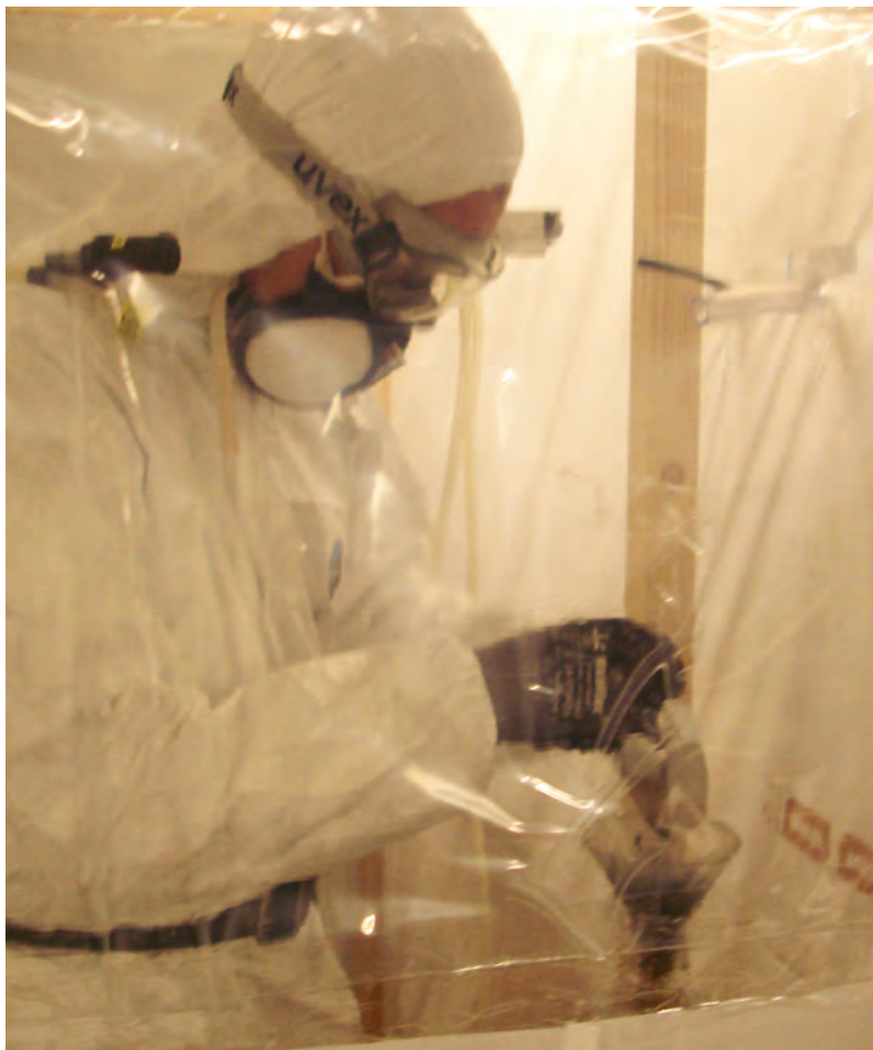
Figur 3. NFA fik en hel tønde kulstofnanorør forærende. Da tønden skulle åbnes og kulstofnanorørene udportioneres i mindre portioner, skete det i et asbesttelt for at mindske en eventuel eksponering. Billedet er taget udefra gennem en plastikrude. Fotograf: Per Axel Clausen, NFA.
