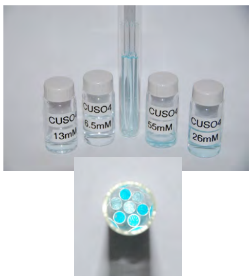
Figur 2. Det eksperimentelle design. Koncentrationen af de 30 prøver er i enhederne 1-7, hvor hver enhed repræsenterer en syvendedel af prøvevolumet. Prøverne er mærket iht. deres koncentration.
