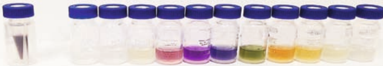
Fraktioner fra ekstrakt af pizzabakke af genbrugspapir. Disse fraktioner blev testet i celletests for hormonforstyrrede effekter.
