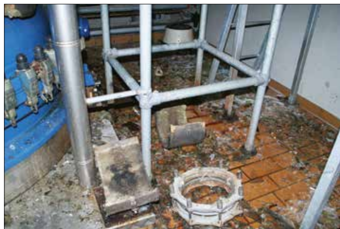
Figur 4. Glassplinter fra ødelagt glaskolonne efter eksplosion af toluendampe grundet statisk elektricitet.
