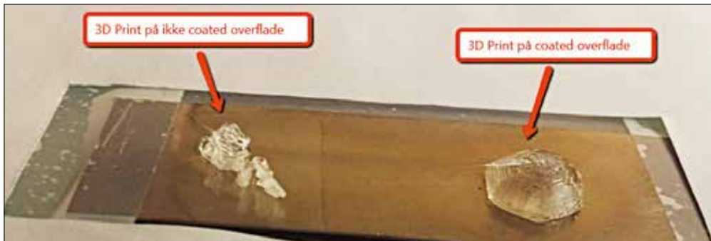
Figur 1. 3D-prints med PMMA filament på en ståloverflade. På den ikke coatede del af overfladen til venstre hæfter printet ikke med et dårligt resultat som konsekvens. På den coatede overflade derimod fås et flot og jævnt print, der er godt bundet til ståloverfladen.
