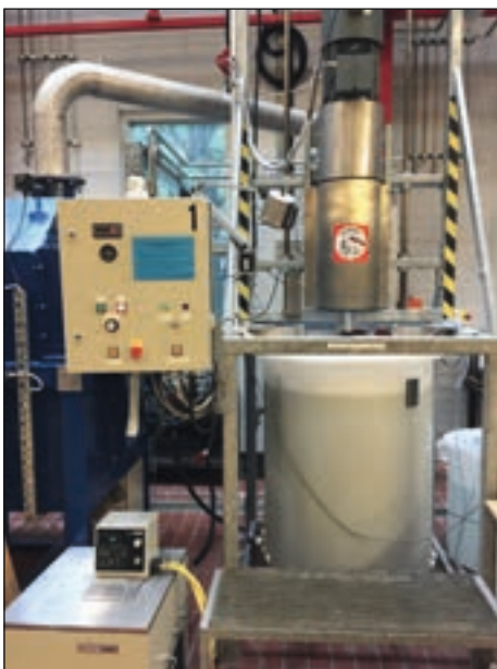
Figur 1. Til venstre: pilot-skala rotorudstyr til måling af friktionsmodstand. I midten: cylindrisk rotor udført i polyvinylklorid (uden påført bundmaling). Til højre: fleksibel rotor (af glat polyoxymethylen) med op til seks kunstige svejsesøm på den ydre overflade.
