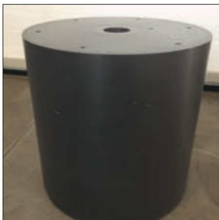
Figur 1. Til venstre: pilot-skala rotorudstyr til måling af friktionsmodstand. I midten: cylindrisk rotor udført i polyvinylklorid (uden påført bundmaling). Til højre: fleksibel rotor (af glat polyoxymethylen) med op til seks kunstige svejsesøm på den ydre overflade.
