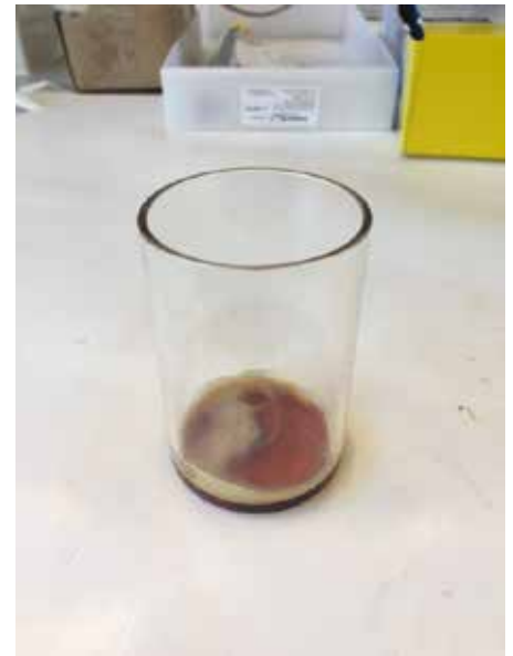
Figur 5. Venstre: Billede af batchreaktoropstillingen, hvor følgende komponenter ses: varmekappe, stålreaktor, omrører, indfødningslinjer samt trykmåler. Højre: Billede af glasforing med en reageret smørelieprøve. Foringen blev placeret inde i stålreaktoren og herefter opvarmet og tryksat med \text{SO}_2 og luft.
