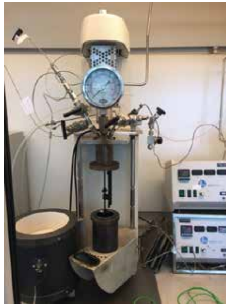
Figur 5. Venstre: Billede af batchreaktoropstillingen, hvor følgende komponenter ses: varmekappe, stålreaktor, omrører, indfødningslinjer samt trykmåler. Højre: Billede af glasforing med en reageret smørelieprøve. Foringen blev placeret inde i stålreaktoren og herefter opvarmet og tryksat med \text{SO}_2 og luft.
