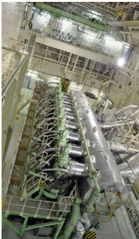
Figur 2. En ottecylindret to-takts marin dieselmotor. Foto: Lektor Philip Loldrup Fosbøl. Gængivet med tilladelse.
