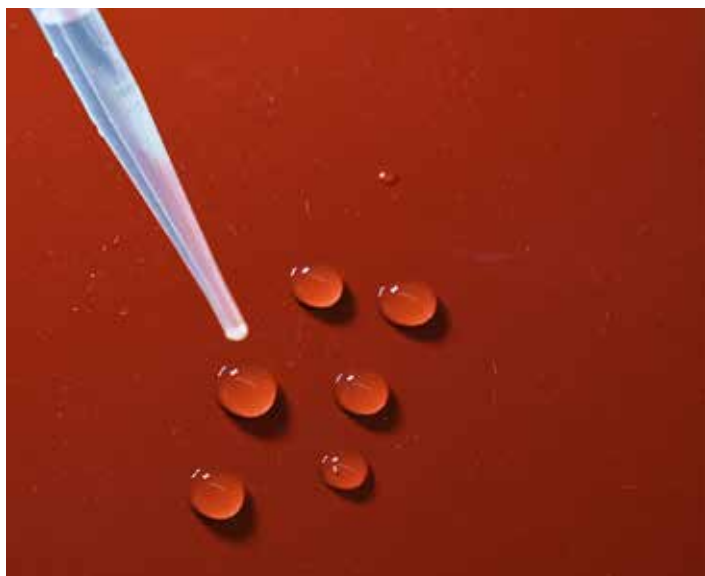
Figur 6. Vanddråber preller af overfladen på en silikoneelastomer på grund af den lave overfladespænding.
