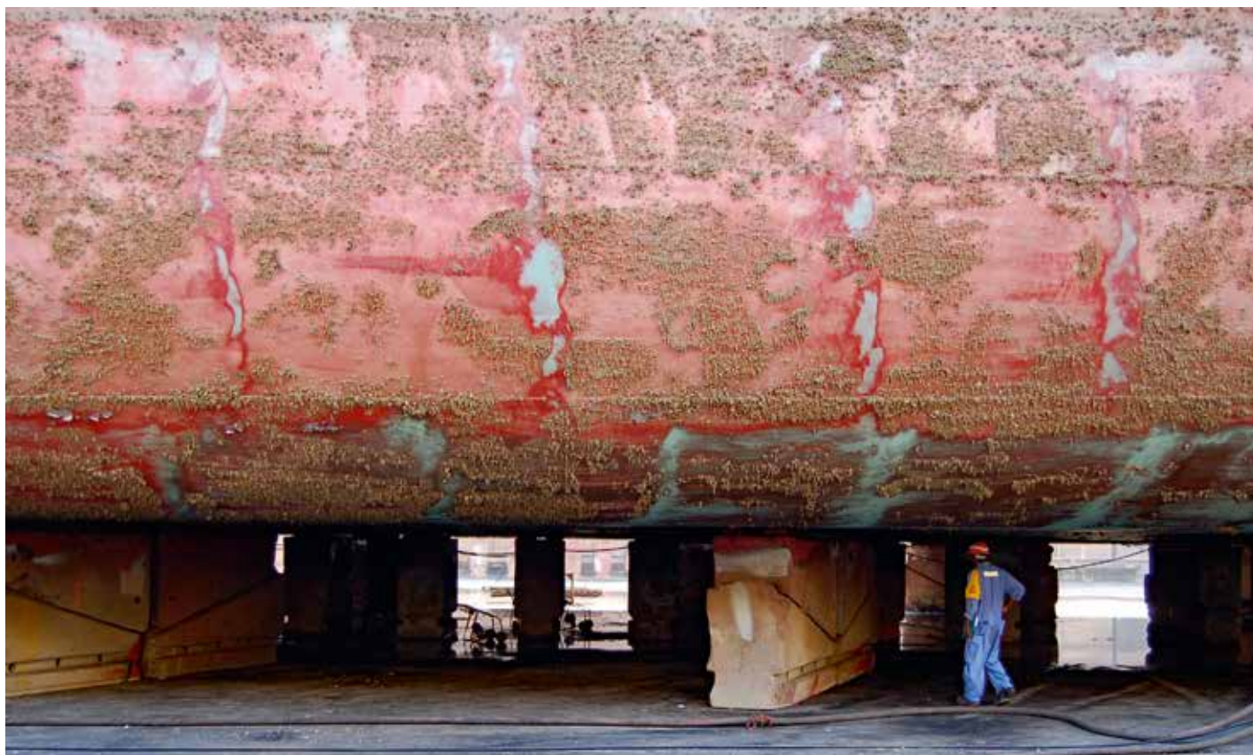
Figur 5. Skibsside med kritisk begroning af marine organismer.
