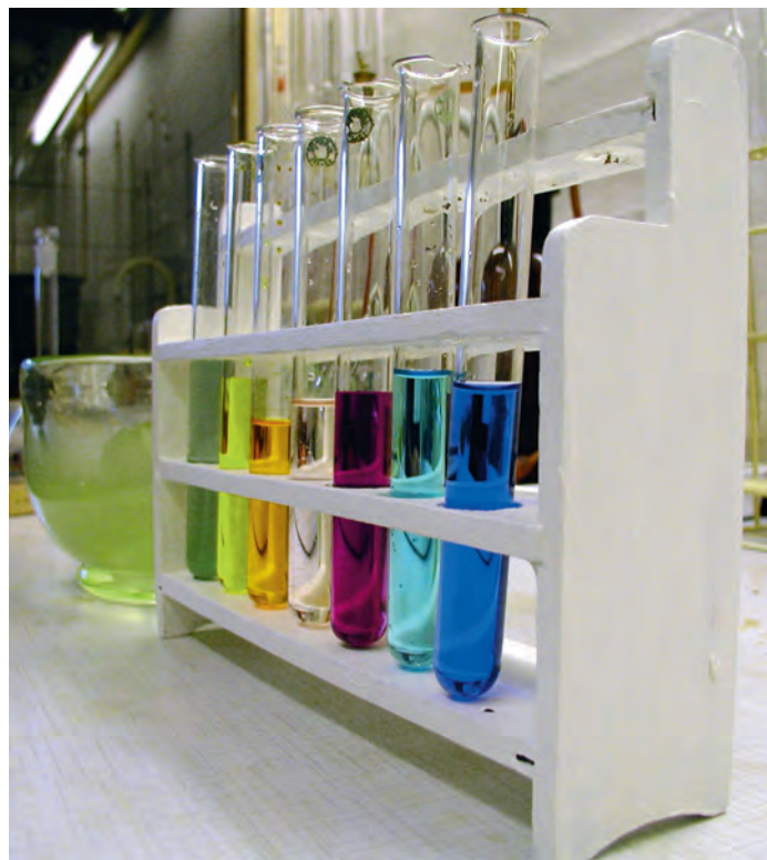
Nogle farvede opløsninger. Fra venstre mod højre: Chromisulfat, kaliumchromat, kaliumdichromat, manganochlorid, kaliumpermanganat, cuprisulfat og cupritetramminsulfat.
