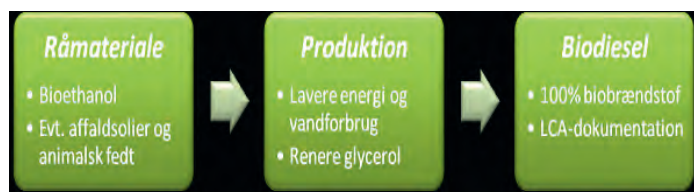
Figur 1. Positive miljøpåvirkninger med enzymatisk FAEE-produktion.
