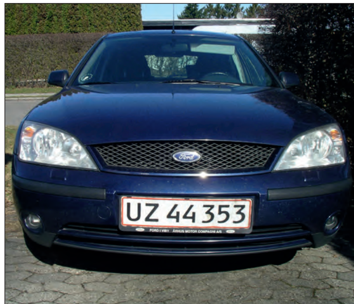
Figur 3. Bil med moderne malingssystem. Øverste lag kan være en 2-komponent polyurethanlak til beskyttelse af de underliggende malingslag mod ultra-violet stråling. Lakken giver samtidig malingssystemet en høj glans.
