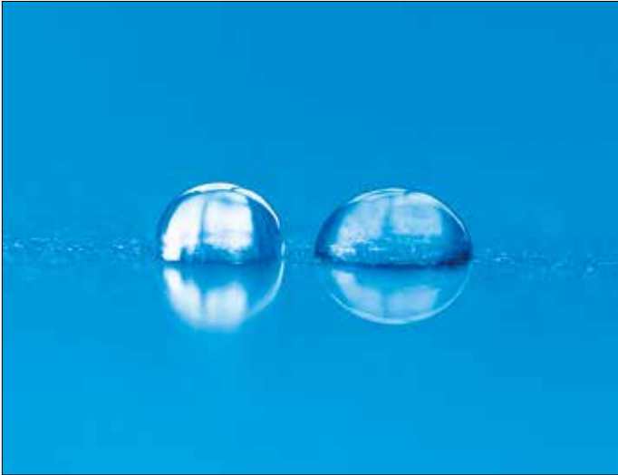
Figur 4. Vanddråber på en hydrofobisk, overfladebehandlet overflade (til venstre) og en hydrofil ståloverflade (til højre).
