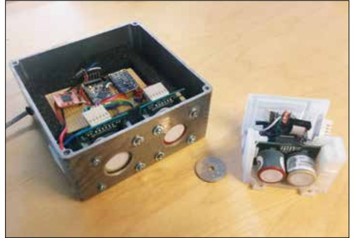
Figur 4. Første sensor-prototype i metalboksen og version 2.0 i den lille hvide plastikboks. Mønten er en dansk to-krone.
