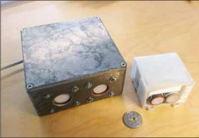
Figur 4. Første sensor-prototype i metalboksen og version 2.0 i den lille hvide plastikboks. Mønten er en dansk to-krone.
