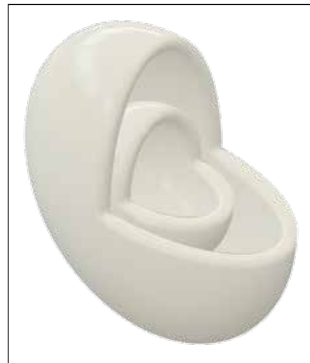
Figur 2. Skematisk repræsentation af en kompartmentaliseret 3D-printet lægemiddelform.
