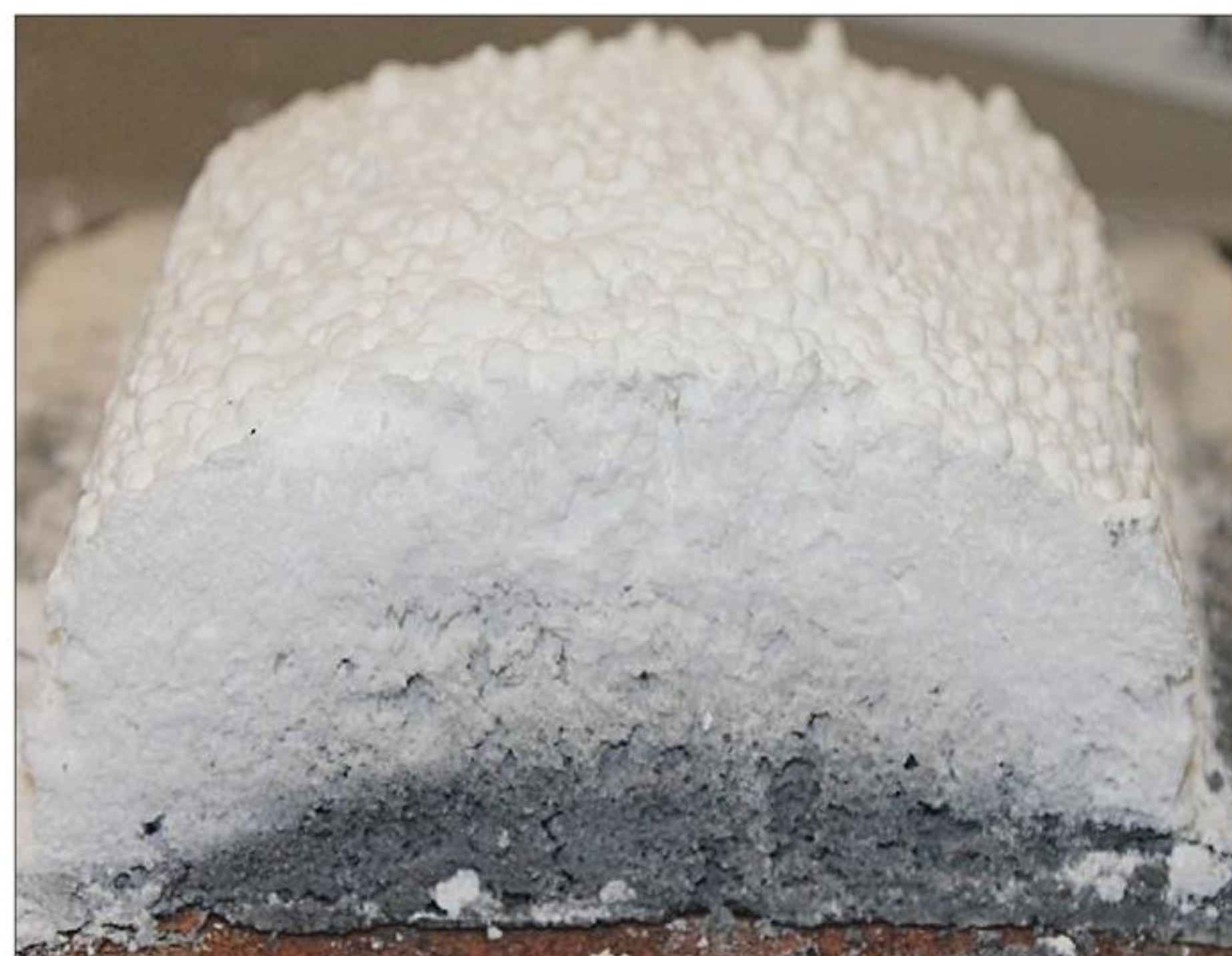
Figur 2. Ekspanderet intumescerende maling på stålplade. Højden af den ekspanderede maling er 7,5 cm.
