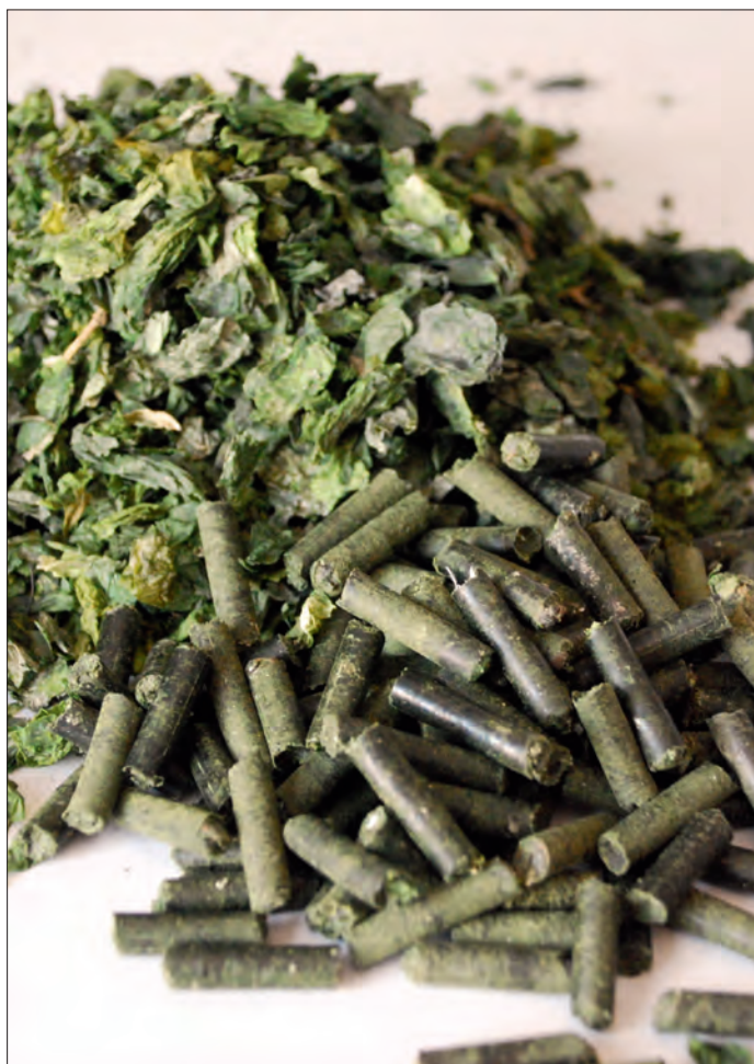
Tørret søsalat og ø6 mm piller. Pillerne har høj mekanisk holdbarhed, dvs. giver lav smuldprocent efter 500 omgange i rullekassen ifølge CEN/TS 15210-1.
