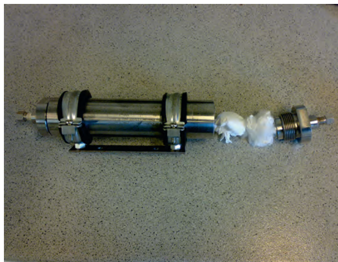
Figur 2. viser et billede af den 100 mL reaktor, der blev anvendt til ekstraktionsforsøgene i superkritisk \text{CO}_2 .
