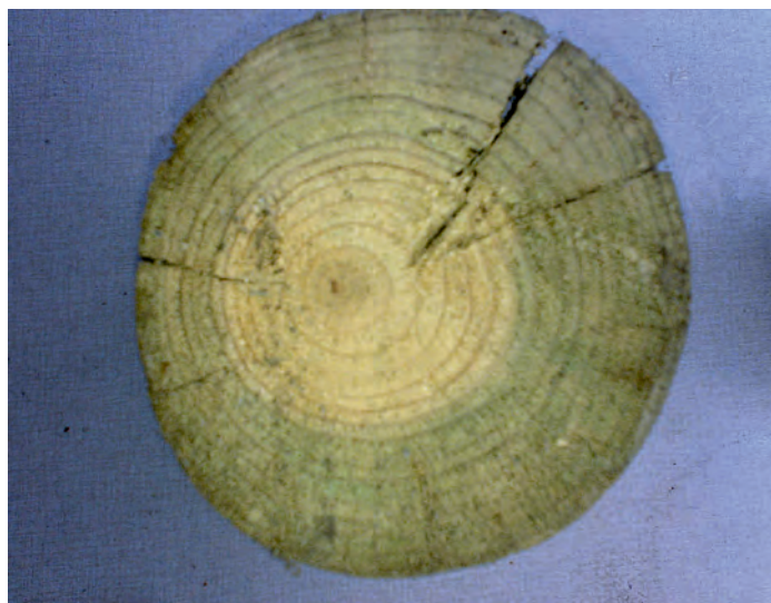
Figur 1. Det inderste kerneved er uberørt af imprægneringen, mens det yderste splintved er farvet af imprægneringen.
