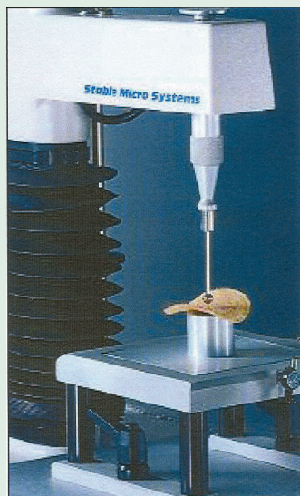
Figur 6. Texture Analyzer og probe til teksturmåling af kartoffelchips.
