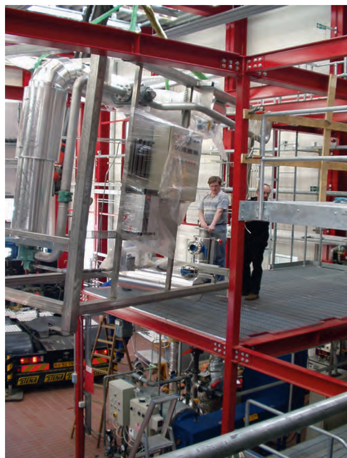
Figur 4. DTU Kemiteknik råder over en stor forsøgshal, hvor det er muligt at udføre forsøg i pilotanlæg. Der er f.eks. opbygget reaktorer, der er specielt velegnet til at studere heterogene reaktioner ved høje temperaturer.
