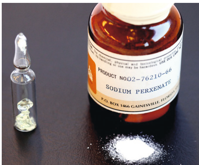
Figur 2. Venstre: Osmiumtetraoxid – en molekylær forbindelse, der smelter ved 40 grader. Højre: Natriumperxenat \text{Na}_4[\text{XeO}_6] \cdot \text{aq} . Den direkte analog til \text{OsO}_4 , nemlig xenontetraoxid er eksplosiv og derfor mindre egnet til hyldeopbevaring end natriumperxenat.
