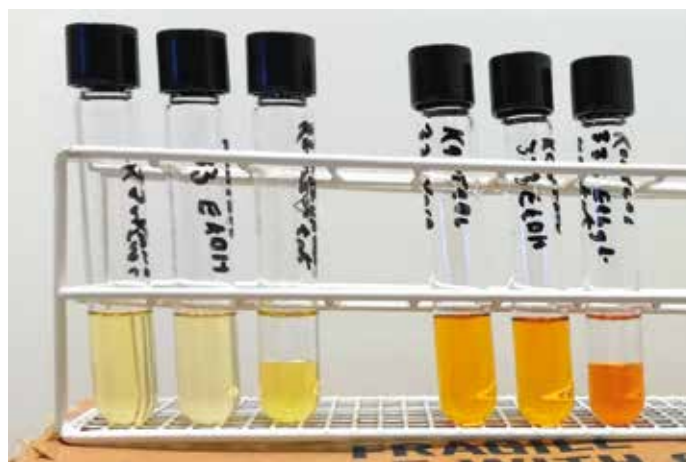
Figur 3. Test af standarder på 33 hhv. 333 ppm H_2O_2 fortyndet i hhv. vand, ethanol og ethylacetat. Ved den lave af koncentrationerne er farveintensiteten lavere med ethanol som solvent, men ikke udpræget ved den høje. Ethylacetat giver et to-fasesystem, hvorved farveintensiteten af vandfasen bliver højere end den tilsvarende vandige standard.
