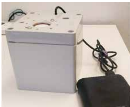
Figur 1. Sensoren, der blev benyttet til målinger af CO 2 . Den er på størrelse med en 50 cl mælkekarton.
