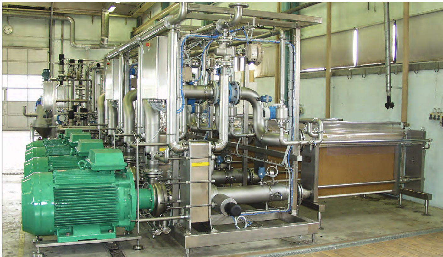
Installation of Alfa Laval M39-modul til fermenteringsindustrien.
