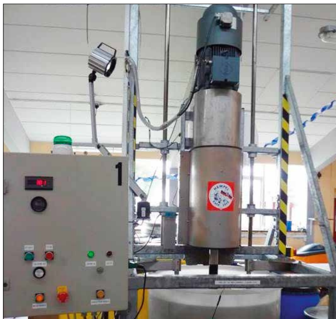
Figur 4. Laboratorie setup til måling af friktionsmodstand på en (begroet) malingscylinder. Siden nævnte er neddyppet i havvand i den hvide tank og kan ikke ses på billedet. Efter [3].
