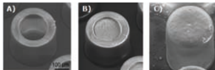
Figur 2. Mikroskopi-billeder af SU-8 mikrocontainere. A) Billedet viser en tom mikrocontainer, B) som derefter fyldes med medicin, C) og til sidst pålægges det pH-følsomme låg, så medicinen kan beskyttes igennem maven og frigives i tyndtarmen.
