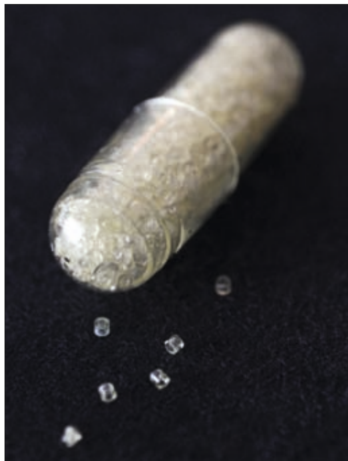
Mikrocontainerne fyldt i en kapsel, som så er klar til fremtidige dyreforsøg. Foto: Jesper Scheel, DTU Nanotech.
