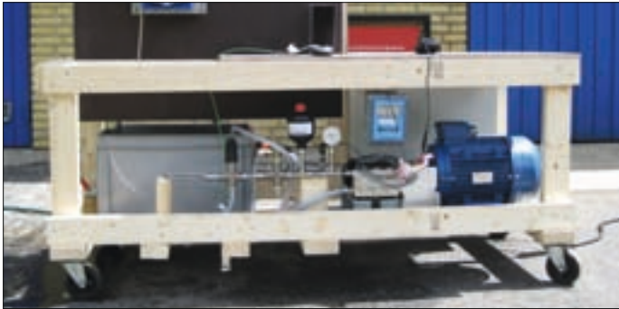
Figur 3. Vandjet apparat på DTU Kemiteknik til eksperimentelle forsøg med blade coatings. Den grå kasse nederst er vandtanken. Selve hjulet med malingsprøver er beskyttet af et kabinet af vandfast træ. Motor og pulsdæmper mv. kan også skimtes. Efter [3].
