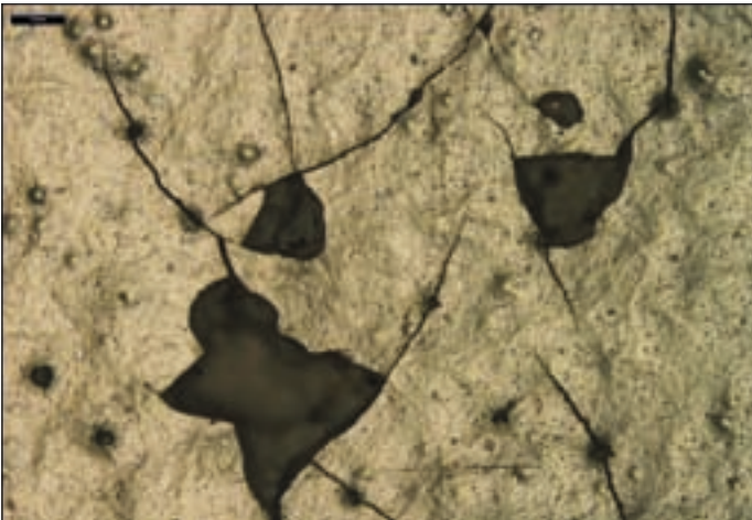
Figur 5. Optiske mikroskopibilleder af en blade coating, som har været udsat for regndråbeerrosion i det nye set-up. Øverst ses en maling, som endnu ikke har været eksponeret. I midten og nederst samme maling efter eksponering. For alle tre billeder gælder, at den lille bjælke øverst i venstre hjørne er 200 \mu\text{m} . Billederne er ikke fra det samme område på malingsprøven. Efter [4].
