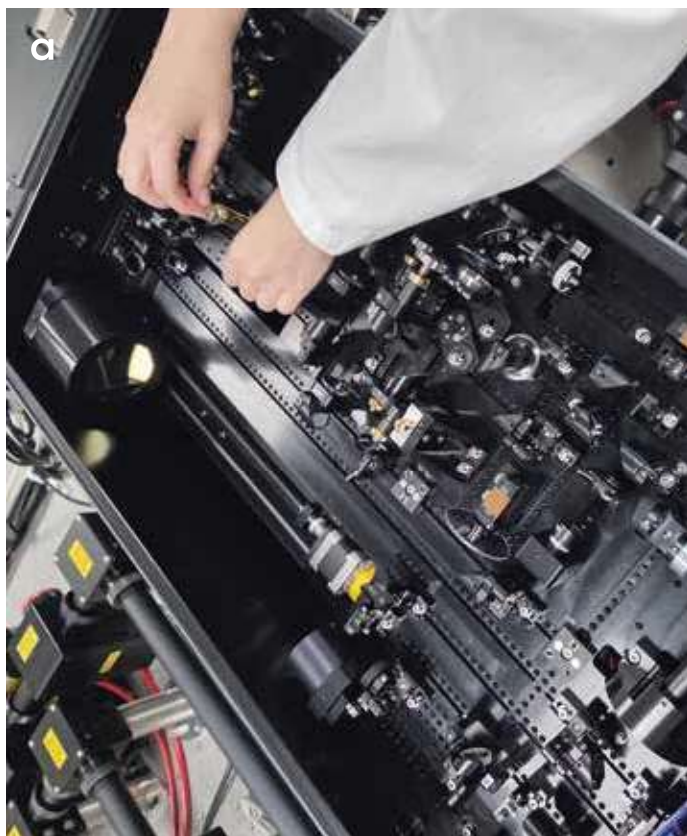
Figur 2. a) En opløsningsprøve i en 0,1 cm kvarts kuvette indsættes i strålegangen i vores transient absorption setup på Syddansk Universitet, hvorefter overlappet mellem excitationsstrålen (pump-pulsen) og det hvide lys (probe-pulsen) i både tid og sted skal optimeres manuelt. b) En prøve exciteres af blåt lys (pump-pulsen) og udsender som resultat orange fluorescens. Probe-pulsen kan ikke ses på billedet, da den har en meget svagere intensitet end den blå excitationsstråle.
