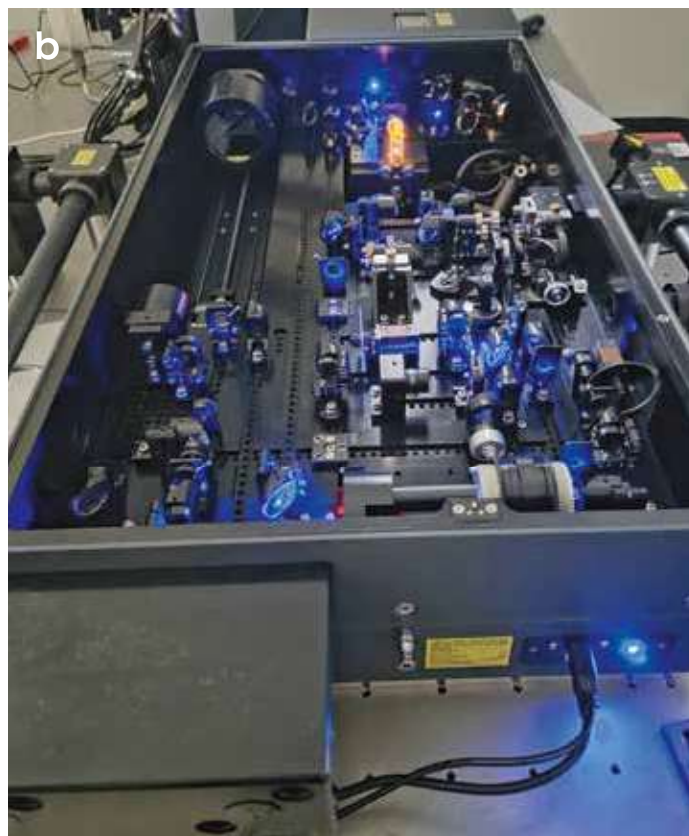
Figur 2. a) En opløsningsprøve i en 0,1 cm kvarts kuvette indsættes i strålegangen i vores transient absorption setup på Syddansk Universitet, hvorefter overlappet mellem excitationsstrålen (pump-pulsen) og det hvide lys (probe-pulsen) i både tid og sted skal optimeres manuelt. b) En prøve exciteres af blåt lys (pump-pulsen) og udsender som resultat orange fluorescens. Probe-pulsen kan ikke ses på billedet, da den har en meget svagere intensitet end den blå excitationsstråle.
