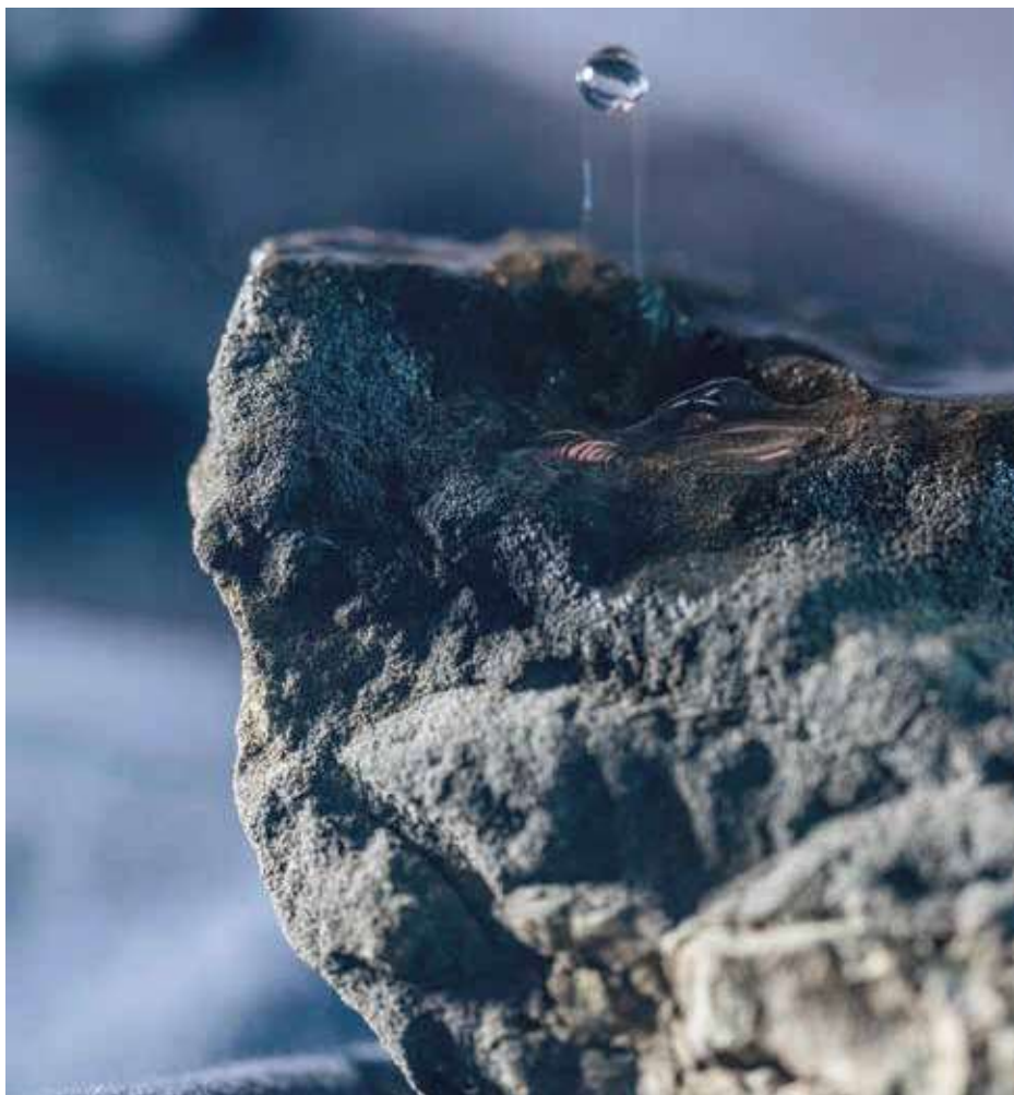
Figur 2. Et stykke vulkansk aske udsættes for vand mættet med CO 2 . Når det svagt sure vand reagerer med mineralerne i asken, frigives blandt andet calcium, der bindes sammen sidenhen med kulstoffet i nye karbonatmineraller. På den måde kan CO 2 i princippet gå fra at være opløst i vand til at blive bundet som fast kalksten.
