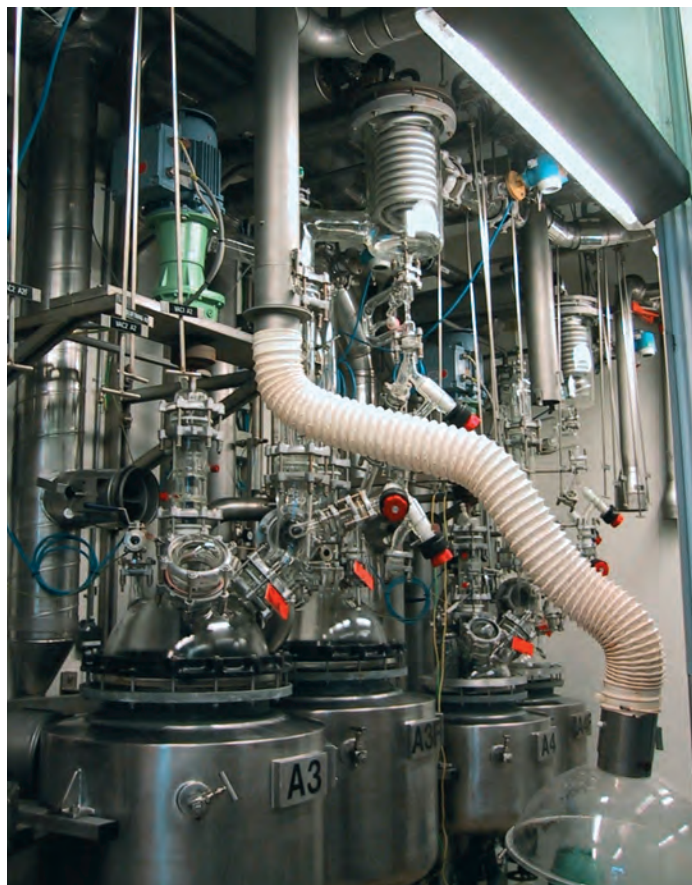
To 50 L og 25 L reaktorer til opskalering af organisk syntese. Foto: Henrik Svane.
