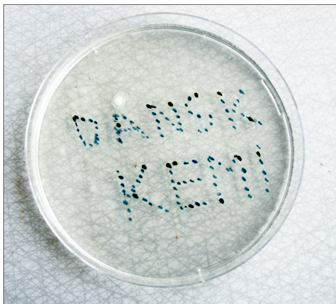
◀ En gel fremstillet af kartoffelmel med lidt kaliumhexacyanoferrat(II) reagerer med en jern(III)-opløsning. Foto: Carsten Christophersen, 2010.
