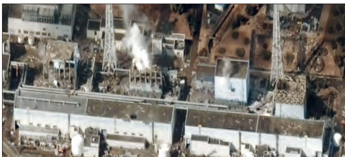
Figur 5. Brinteksplosioner (detonationer) raserede tre af fire reaktorbygninger på det japanske atomkraftkompleks Fukushima Daiichi i marts 2011. Ulykken har kastet atomkraft ud i sin måske hidtil største krise. (Foto: Digital Globe, Wikimedia Creative Commons).
