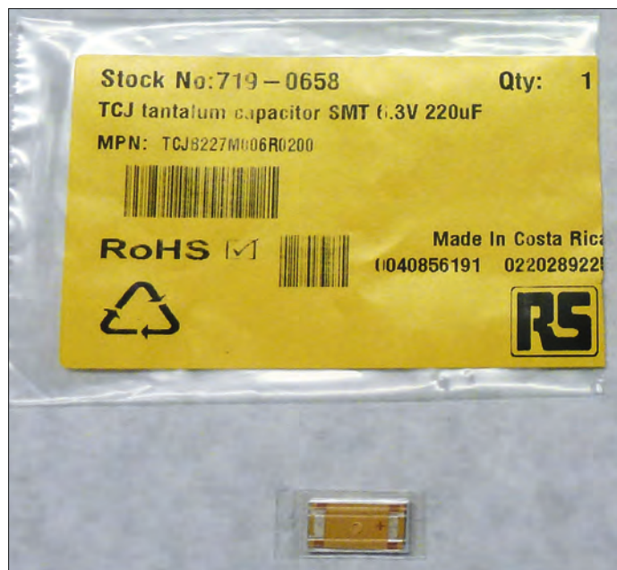
Ta-kondensatorer til XRF-undersøgelser; eget foto.
