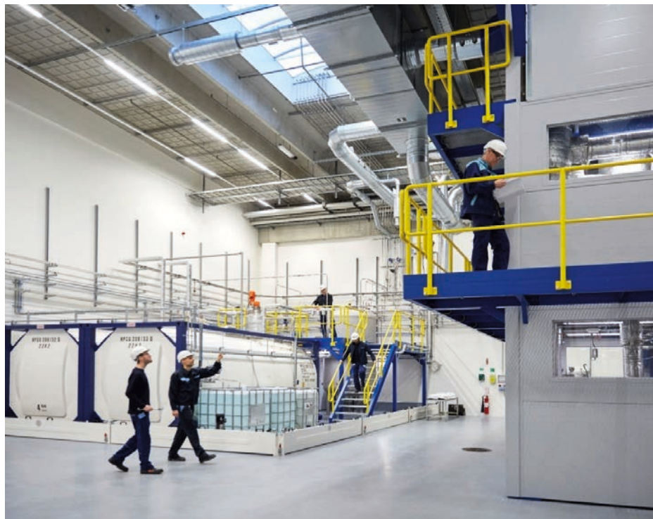
Figur 5. Sukkerkrakning demonstrationsanlæg i Lyngby med 50 kg/time kapacitet.
