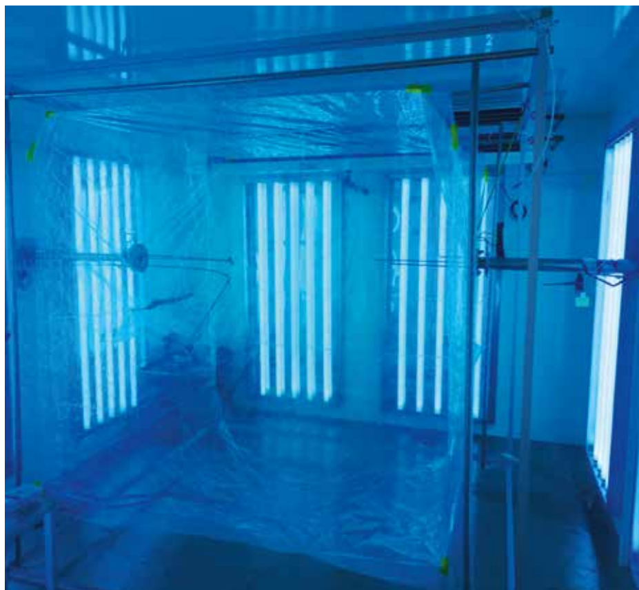
Det indre af ACTRIS-DK forsøgsplatformen på Kemisk Institut, Københavns Universitet. Aerosoler dannes inde i et teflon-reaktionskammer under påvirkning af ultraviolet lys i et temperaturkontrolleret rum.
