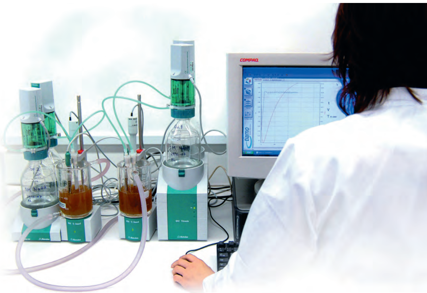
Figur 1. Dynamisk laboratoriemodel for lipolysen under fedtfordøjelsen i tarmen: Modellen omfatter et termostatstyret reaktionskammer, en computerkontrolleret pH-stat med en automatiseret burette for tilsætning af natriumhydroxid samt en burette til kontinuert, kontrolleret tilsætning af calciumchlorid. Alle forsøg udføres under omrøring. Foto: Lægemiddelforskning 2007.
