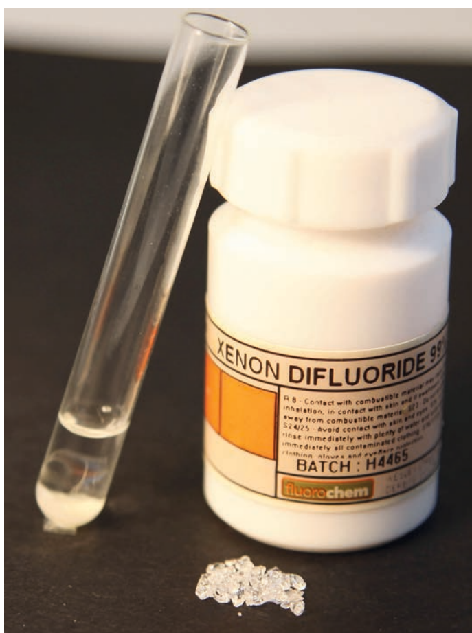
Figur 1. \text{KBrO}_4 (reagensglas) fældet ved oxidation med xenondifluorid (farveløse krystaller foran teflonbeholder).
