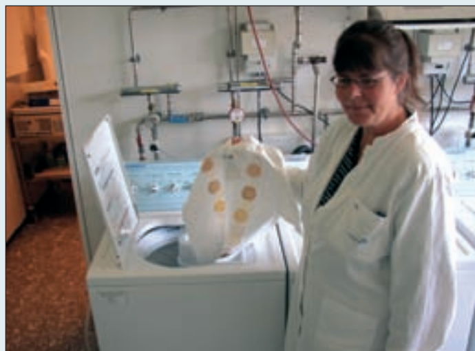
Figur 2. Laborant Marianne Valente, Novozymes, ved en nordamerikansk vaskemaskine af top loader- (eller vertikal-akse-)typen. En maskine af denne type tager omkring 60 L vand ind i programmet til »medium load« (op til 5 kg tøj). Der er ikke noget varmelegeme i maskinen, så den kan køre med husets kolde vand, husets varme vand eller en blanding. Bemærk det lille trekantede rum forrest til højre. Det er til »chlorine bleach«, dvs. hypochlorit (se senere artikel om blegemidler).
