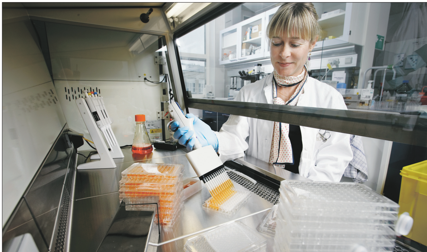
Figur 3. Sterilteknisk arbejde i laminar flowbænk mhp. at minimere risikoen for kontaminering af cellekulturen.
