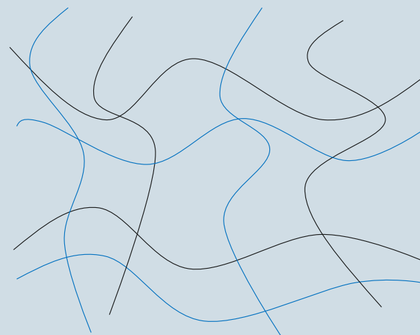
Figur 6. Illustration af et interpenetrerende polymernetværk. Det blå og det sorte polymernetværk er sammenflettede og kan derfor ikke separeres.
