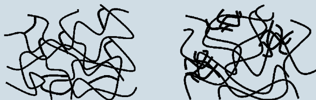
Figur 5. Illustration af to typer af bimodale netværk. Til venstre ses et bimodalt netværk med en ikke-kontrolleret fordeling af de korte polymerkæder og til højre ses et bimodalt netværk med en kontrolleret klynge-distribution af de korte polymerkæder. Denne konfiguration giver et lavt elastisk modul og reducerer desuden det viskøse tab i materialet (4). De gode egenskaber skyldes, at de korte polymerklynger fungerer som forstærkende elementer i netværket, og de lange kæder bevirker meget høj strækbarhed.
